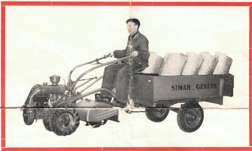
**4 Arbeitsgänge und Rückwärtsgang in jeder Richtung — Kupplung und kräftige Getriebebremse**
