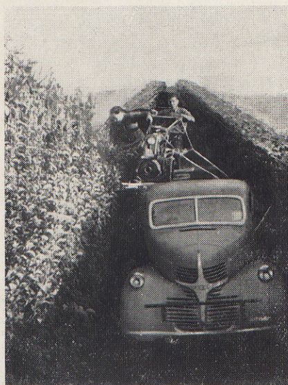
La motofalciatrice Simar su autocarro per il taglio orizzontale delle siepi.
